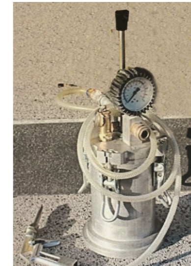
Drucktopf für kleine Maßnahmen von der Dirk Hünninghaus GmbH
